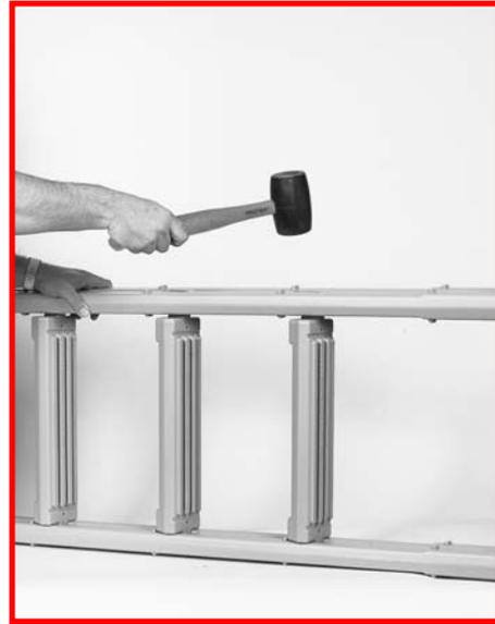
**7.** Tapez légèrement à l'aide du maillet sur le montant de l'échelle, pour permettre aux extrémités des marches de s'y enfoncer.
