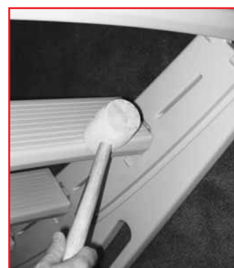
N° 8 : Taper les 4 échelons vers le bas jusqu'à ce qu'ils soient en place.
